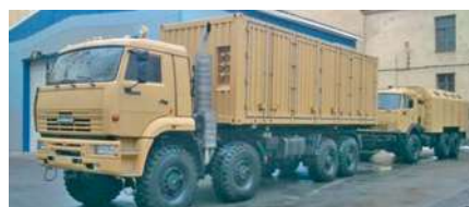
Мобильная установка для обеззараживания одежды, обуви, документов и личных вещей от патогенных микроорганизмов УМО
